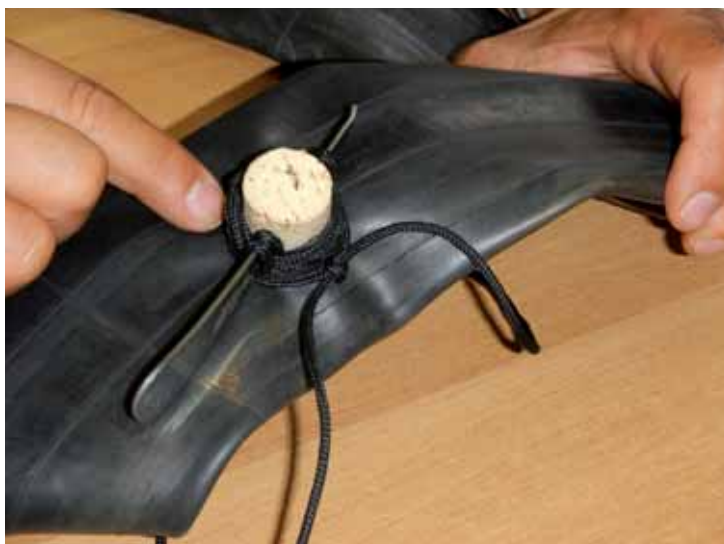
Tecniche di riparazione di una falla con sughero e paracord
